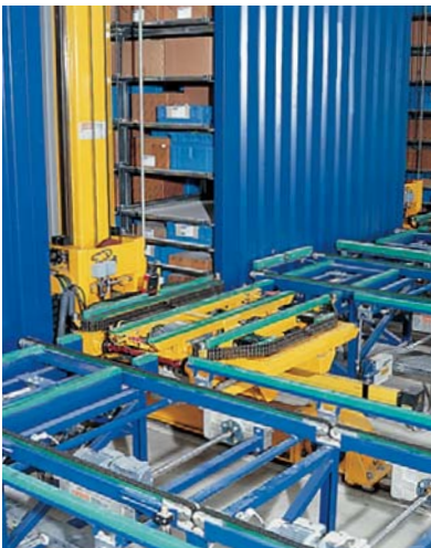
RBG in Übergabe- bzw. Übernahmeposition zur Hubgleitstation
